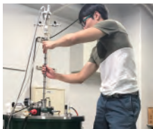
超電導マグネットに測定用プローブインサートを挿入
