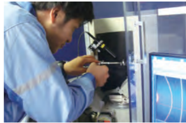
X線残留応力測定準備
