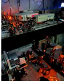
過渡吸収測定で用いた光学機器とフェムト秒パルスレーザー光
