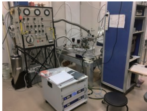
極低温高磁場で物性測定をするための冷凍機と超伝導磁石
