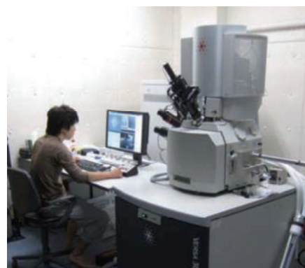
FIB-SEM による TEM 試料等のナノスケール微細精密加工
