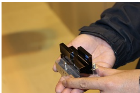
実際に実験でも用いる分光用 Si 単結晶
