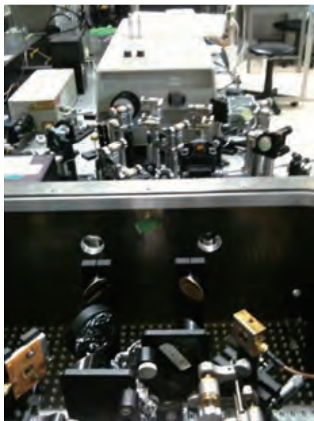
図 超短パルスレーザー(奥)をテラヘルツ波発生・検出に用いる実験系
