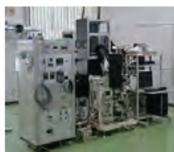
パルスレーザー堆積法装置
