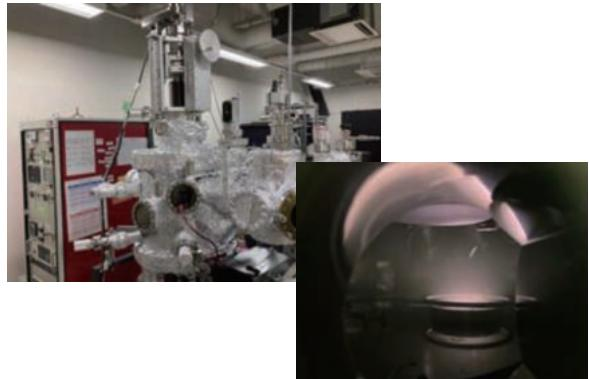
スパッタ装置および薄膜作製の様子
