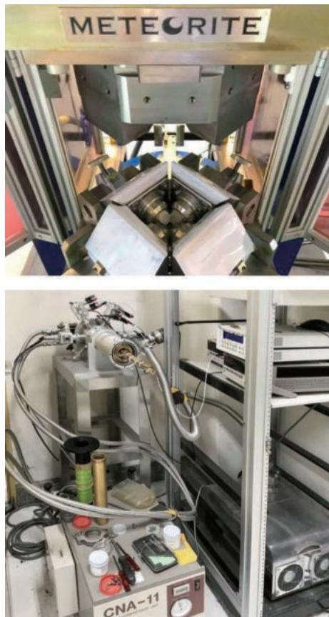
実験設備: 高圧合成用 700 トンプレス
