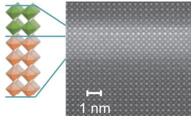
原子レベルで制御された強相関電子系界面の断面透過電子顕微鏡像
