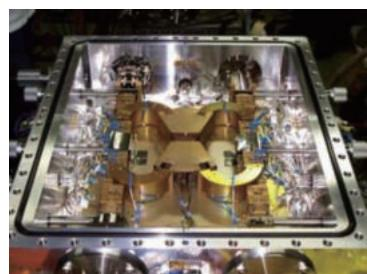
マルチターン飛行時間型質量分析計
