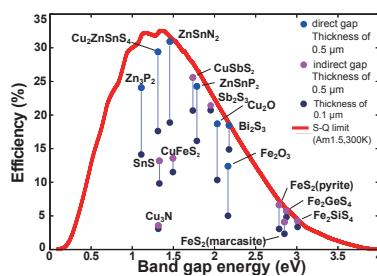
図：太陽電池材料の Shockley-Queisser 理論による効率予測
